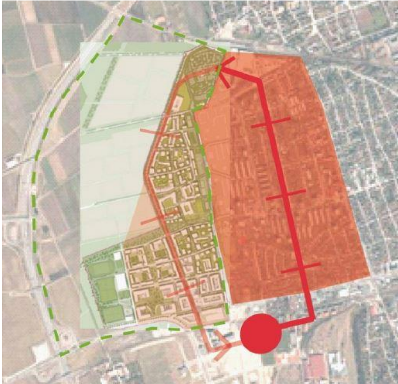
Bild 2: Geothermische Nahwärmeversorgung von Altbestand (rechts) und Neubaussiedlung (links) Foto: Ingenieurbüro Hausladen
